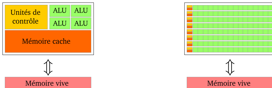
(a) Le CPU comporte davantage de cache avec un nombre réduit d'unités de calcul (ALU).
